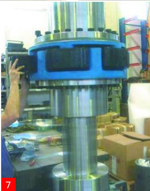
7. Detalles del desmontaje de los elementos flexibles en un acoplamiento MMG 25000 tipo F1.
