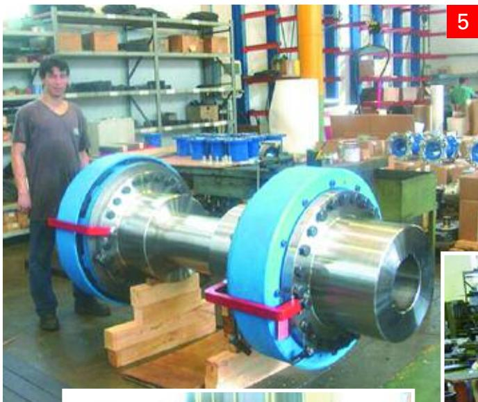
5. Acoplamiento de ejes MMG 25000 tipo F1 en una línea de recocido y decapado de acero.
