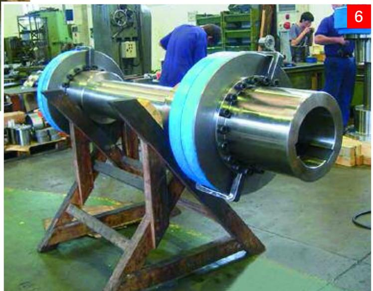
6. Acoplamiento de ejes MMG 10000 tipo F1 en una línea de recocido y decapado de acero.
